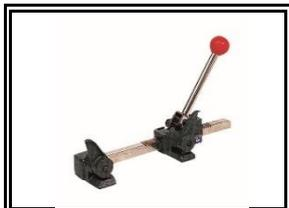
本機は帯鉄を必要寸法に切断しておき、帯鉄の両端を引っ張りシールする方法。同一寸法の物を大量に梱包する場合に最適です。
